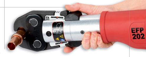
Fino al momento di erogazione della forza, cioè fino al momento di inizio della fase di pressatura, è possibile interrompere la procedura rilasciando il tasto di avvio. Una volta avviata la fase di pressatura, l'apparecchio si trova in ciclo forzato e, per motivi di sicurezza, è possibile riaprire la pinza di compressione solo al termine del processo di pressatura. Dovesse essere necessario interrompere la pressatura, è possibile rilasciare la pinza azionando lo sblocco manuale.
